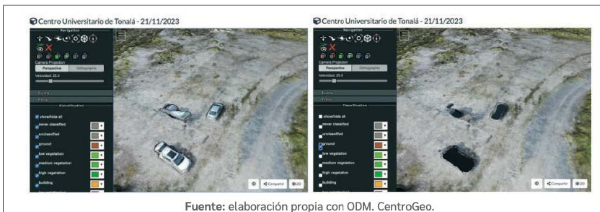
ILUSTRACIÓN 4. VISUALIZACIÓN DE UNA NUBE DE PUNTOS EN UN LEVANTAMIENTO DE CAMPO.
